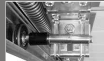
wartungsfreie kugelgelagerte Nylonlaufrollen
